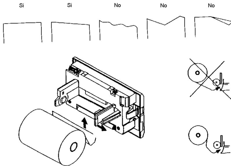
Retire el tubo vacío y coloque el rollo nuevo según el gráfico. Presione varias veces el botón del frente de la impresora hasta que el papel salga por el frente.
