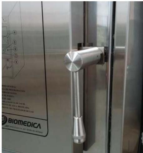
Abra la puerta de la cámara y cargue el canasto de la misma con el material a esterilizar, recomendamos que el mismo no entre a presión ya que esto disminuye el rendimiento del ventilado y baja la penetración del gas en las bolsas interiores.
