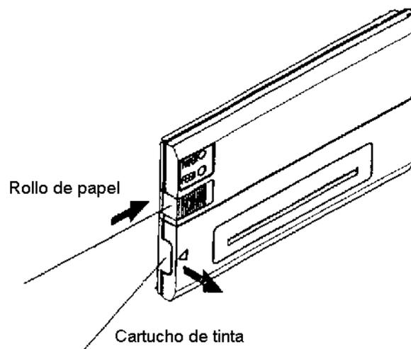
Presione la traba indicada para el cambio del rollo de papel y abra la tapa girando hacia la derecha
