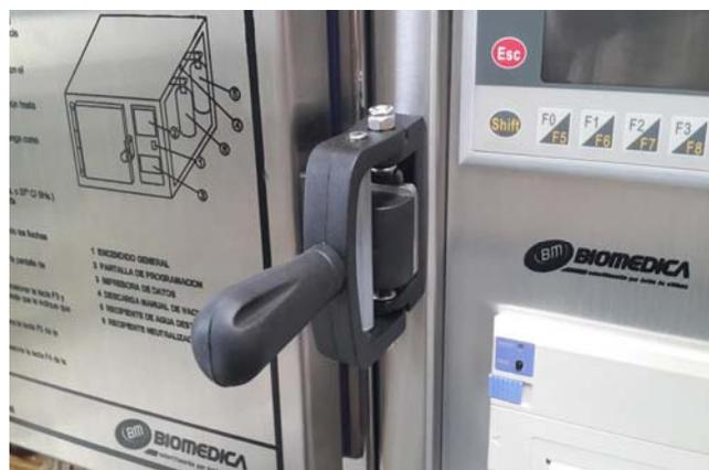
Abra la puerta de la cámara y cargue el canasto de la misma con el material a esterilizar, recomendamos que el mismo no entre a presión ya que esto disminuye el rendimiento del ventilado y baja la penetración del gas en las bolsas interiores.
