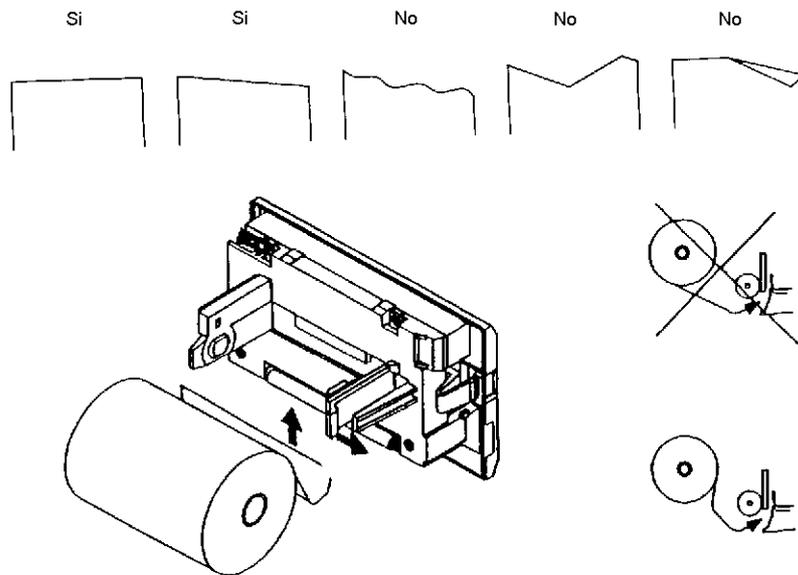
Retire el tubo vacío y coloque el rollo nuevo según el grafico. Presione varias veces el botón del frente de la impresora hasta que el papel salga por el frente. Cierre la tapa y corte el papel sobrante.
